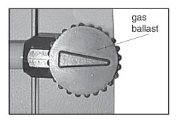
For **condensable vapours** (water vapour, solvents, ...):
